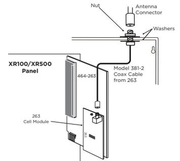
Figure 2: 464-263LTE-V5 Wiring
